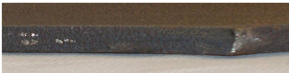
Obr. 1: Detail vyválcovaného polotovaru v kvalitě po zavedení nové technologie
